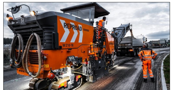
Abb. 2: Belagsfräse der Firma Reproad Reproad.com
