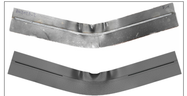
Deformationen in Versuch und Simulation für einen lasergeschweißten Blechstreifen unter 3-Punkt-
