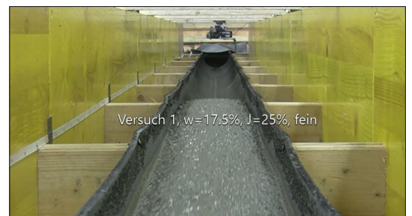
Versuchsdurchführung: Reihe mit Wassergehalt 17.5%, Neigung 25% fein (Kameraaufnahme von oben) Eigene Darstellung
