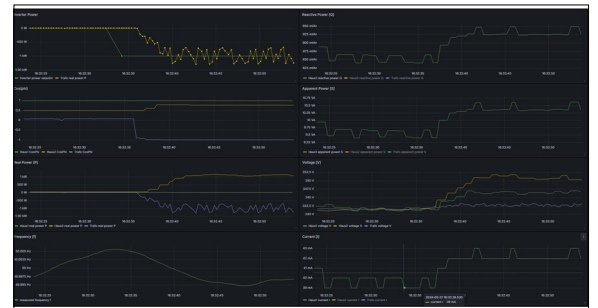
Messung des Ansprechverhaltens des PV-Inverters Eigene Darstellung
