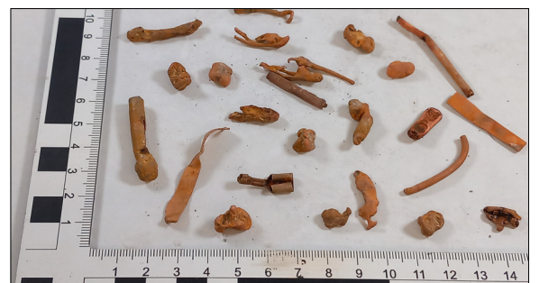
Nach der Oberflächenbehandlung abgetrenntes Kupfer Eigene Darstellung
