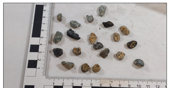
Nach der Oberflächenbehandlung abgetrenntes Zink Eigene Darstellung
