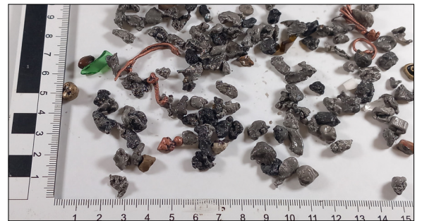
Rohmaterial der Korngrösse 4-8mm Eigene Darstellung
