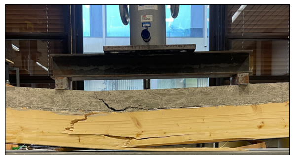
Abbildung 2: Biegebruch im Holz Eigene Darstellung
