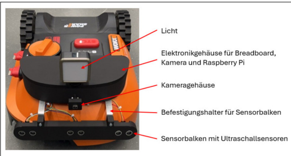
Mähroboter mit Igelschutzmodul Eigene Darstellung
