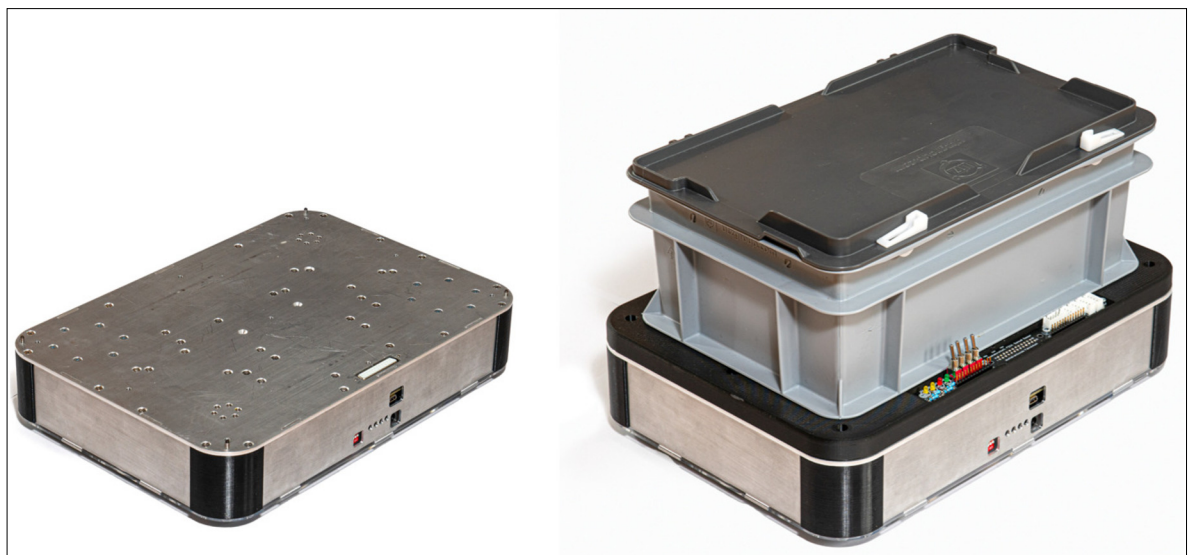
Modulares Fahrwerk (links) zum Transport von Bauteilen in der Mikrologistik; Bsp. eines UTZ-Stapelbehälters (rechts) Eigene Darstellung
