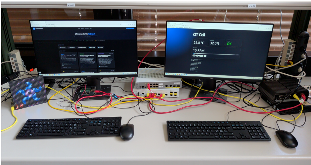
Abbildung 1.: Physischer Laboraufbau mit den Client-Arbeitsplätzen der Benutzerrollen Alice und Bob sowie der Lüfter-Simulation auf einer LED-Matrix
