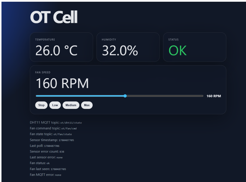
Abbildung E.5.: OT-Dashboard mit DHT11-Sensordaten und Lüftersteuerung
