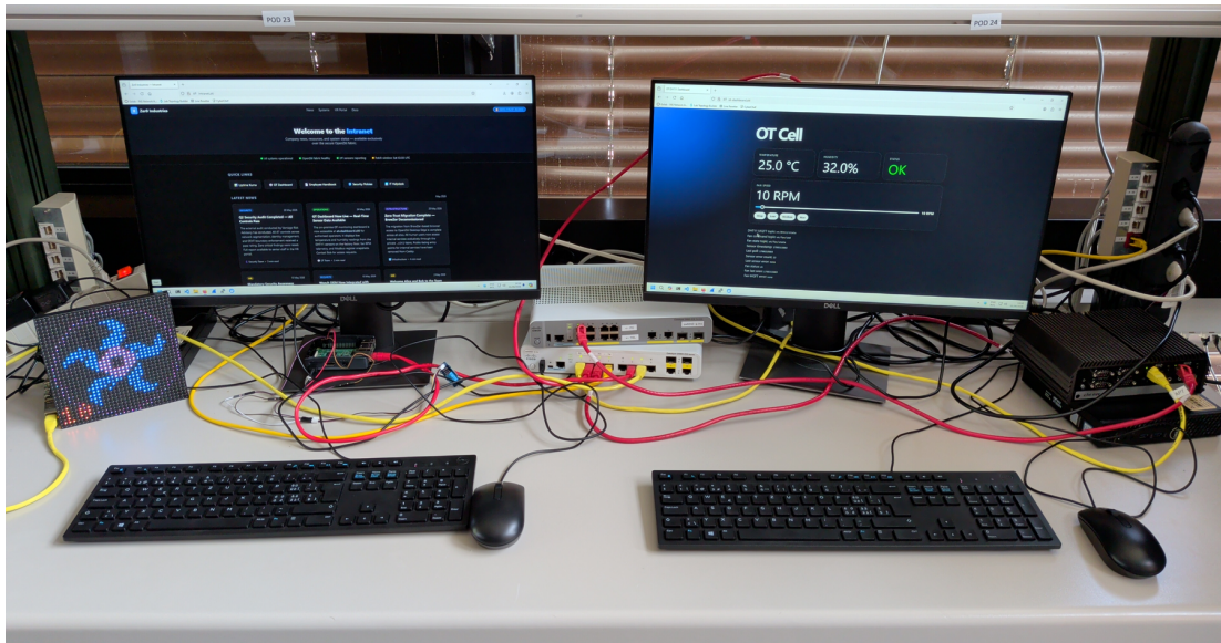
Abbildung 2.1.: Physischer Laboraufbau mit den Client-Arbeitsplätzen von Alice und Bob sowie der Lüfter-Simulation
