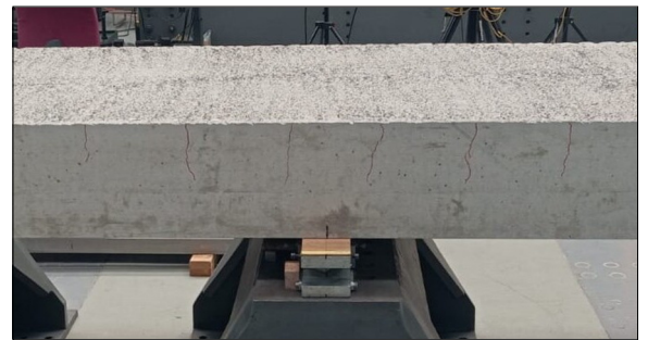
Probekörper nach der Vorbelastung; Rissbildung oben am Querschnitt Eigene Darstellung
