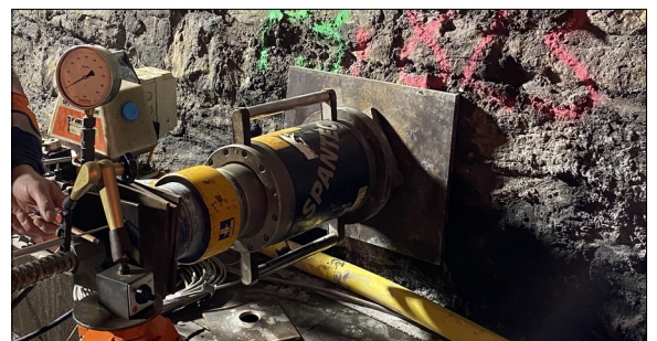
Eignungsprüfung (Ankerzugversuch) bei Opfernägel Eigene Darstellung
