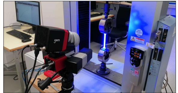
Abb. 2: Eingespannter Prüfkörper aus Polycarbonat für die Durchführung des Hysterese-Verfahrens Eigene Darstellung
