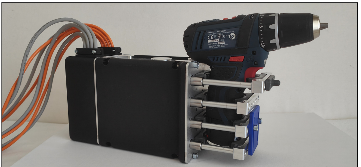
Prototyp des Greifers mit Akkuschrauber Eigene Darstellung
