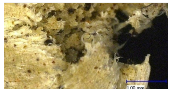
Abb. 3 V3_RBM-MPBAT Zugstab Bruchfläche Eigene Darstellung
