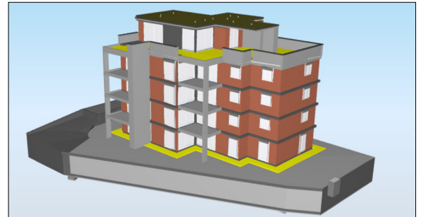
Erstelltes Analysemodell mit SCIA AutoConverter (Umwandlung IFC- zu SAF-Format) Eigene Darstellung
