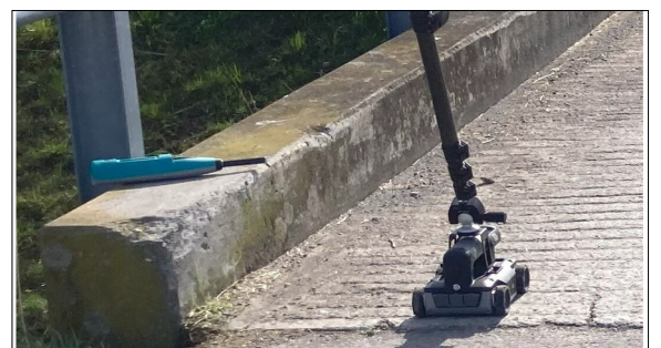
Georadar und Rückprallhammer Eigene Darstellung
