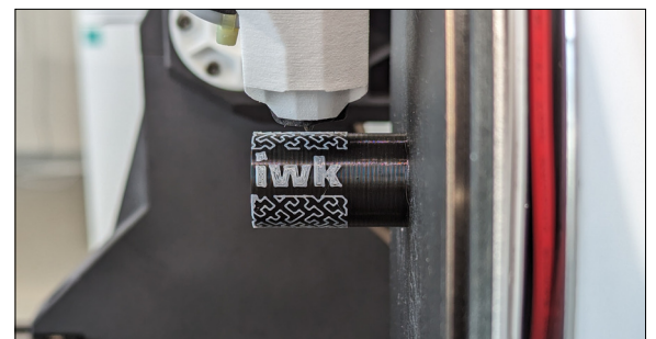
Einfacher Demodruck anhand bedruckter Zylindermantelfläche Eigene Darstellung
