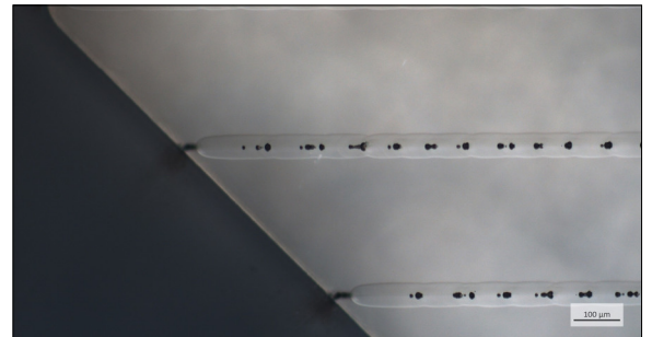
Mikroskop-Aufnahme einer Mikro-Chevron-Teststruktur mit uneinheitlicher Verteilung der Bondstärke Eigene Darstellung
