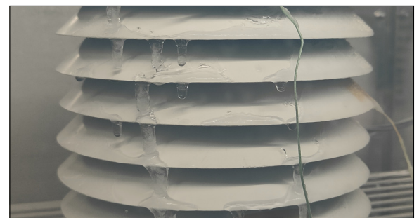
Schmelzendes Eis auf dem beheizten Sensorgehäuse während des Deicing-Versuchs in der Klimakammer Eigene Darstellung
