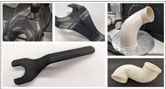
Bild 2: Links: Gabelschlüssel in der Herstellung mit Ablage der Endlofasern; Rechts: 5-Achs-gedrucktes Abflussrohr Eigene Darstellung
