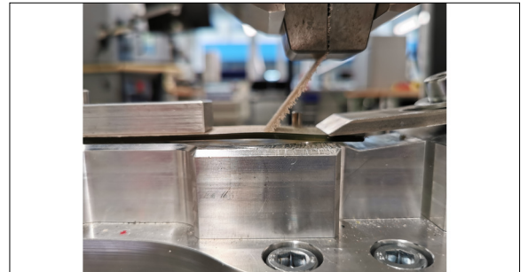
Aufgespritzter Tubus für Haftungsuntersuchungen (Zugversuch) Eigene Darstellung
