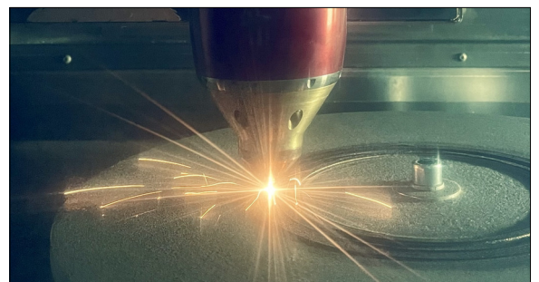
Beschichtung des Testsubstrats Eigene Darstellung
